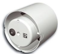
Осевые вытяжные вентиляторы серии PUNTO GHOST предназначены для удаления воздуха через воздуховоды длиной до 4-х метров. Вентиляторы этой серии предназначены специально для скрытой установки в каналах. Корпуса вытяжных вентиляторов выполнены из ABS пластика, стойкого к воздействию ультрафиолетового излучения. Вытяжные вентиляторы PUNTO GHOST идеально подходят для вентиляции небольших кухонь, санузлов и подсобных помещений.
