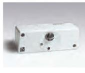
Автоматически включает, выключает или переключает скорости вентилятора, когда температура воздуха в зоне датчика превысит установленный регулятором на корпусе предел от 10 до 40 °С. После снижения температуры, встроенный таймер обеспечивает задержку, в зависимости от уставки, (от 3 до 20 мин) выключения, включения или обратного переключения скоростей вентилятора.
