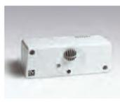
Автоматически включает, выключает или переключает скорости вентилятора, когда задымленность или запыленность воздуха в зоне датчика превысит предел, установленный регулятором на корпусе. После снижения концентрации в воздухе дыма и пыли ниже установленного предела, встроенный таймер обеспечивает задержку, в зависимости от уставки (от 3 до 20 мин), выключения, включения или обратного переключения скоростей вентилятора.
